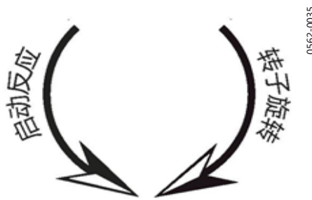
图27 旋转方向 (设备顶部往下看)
